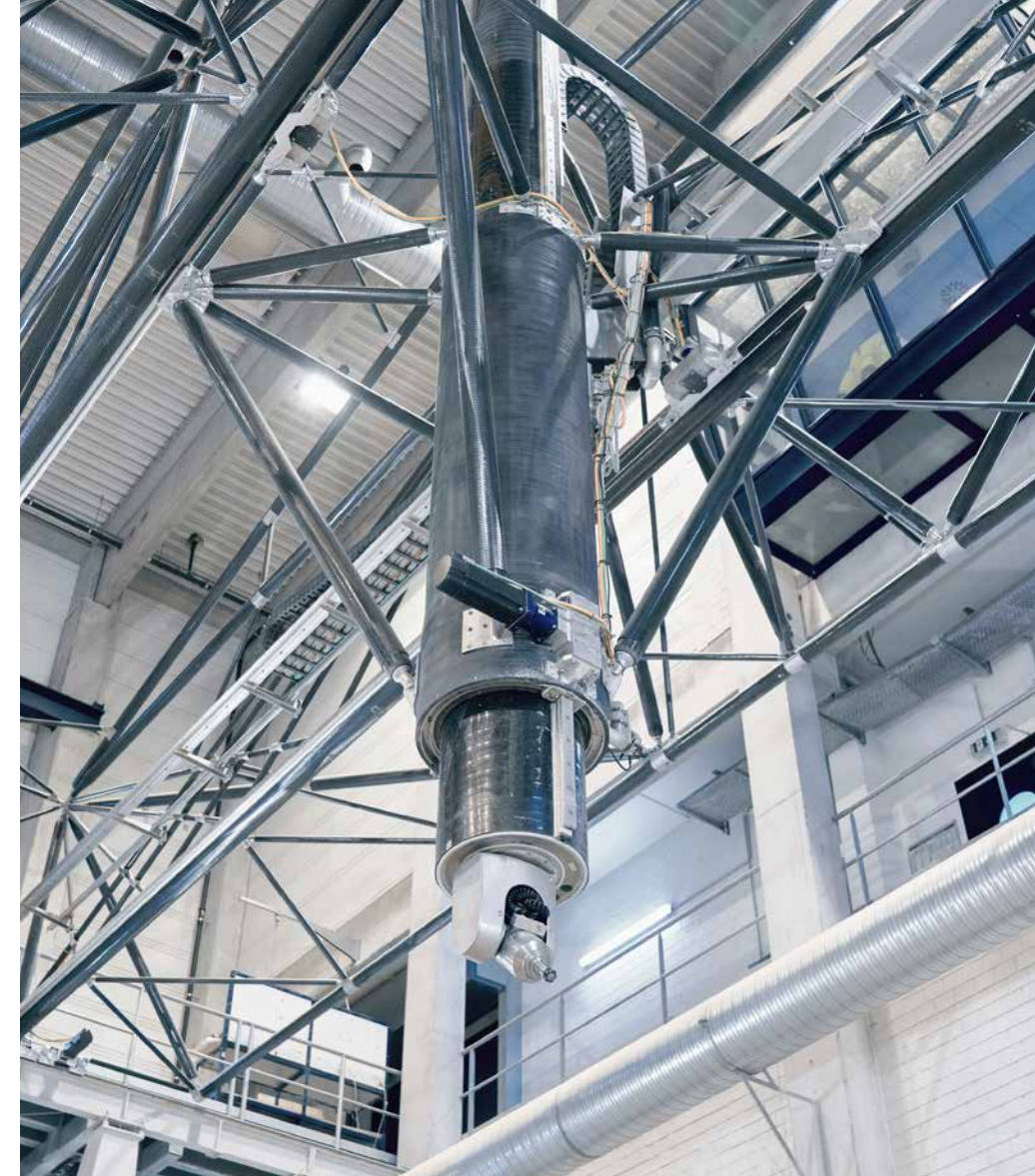
Das rundum erneuerte Portal bearbeitet den unteren Bereich der Werkstücke von ca. 1 m bis 4 m Höhe.
